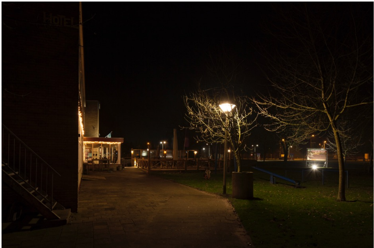
Foto: Morenelaan in Kraggeburg. Lantaarnpaal staat in de boom en geeft niet voldoende licht meer op de weg daardoor. Door goede afstemming kan dit voorkomen worden.
